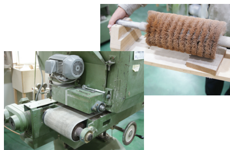
専用のブラシで浮造り加工もできる
