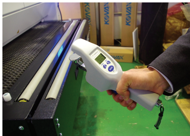
厚み測定を簡単に行うワイヤレスキャリア
