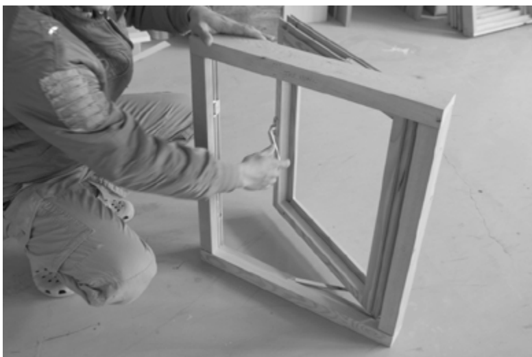
押し縁も枠材と一体型施工できるので木目も合う
