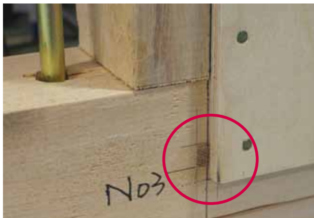
3体目の試験でー16kNで加力 右辺に2ミリずれた
