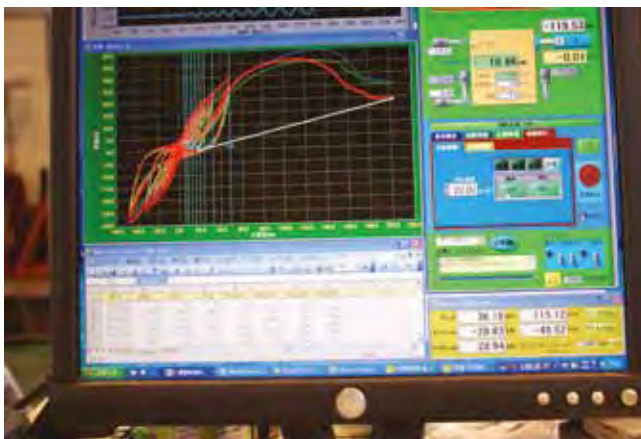
試験終了後の履歴 3体とも安定してバラツキが少ない
