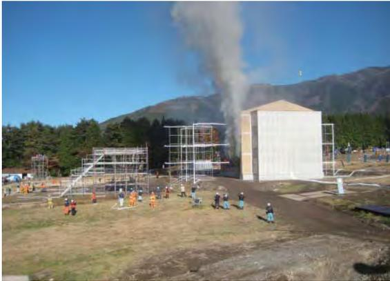
準耐火構造の校舎火災実験（岐阜県下呂市）
