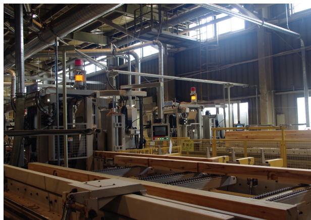
横架材中間加工機 MPS-15B
