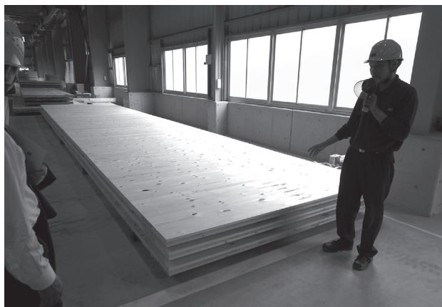
国内で製造できるCLTの最大サイズは3m×12m
