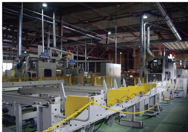
5種類の金物工法に対応した加工機も2ラインで並走
