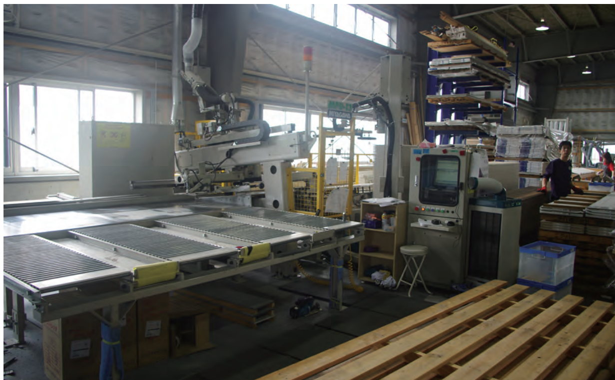
圧倒的な加工スピードを持つ全自動サイディング加工機「MPD-13」
